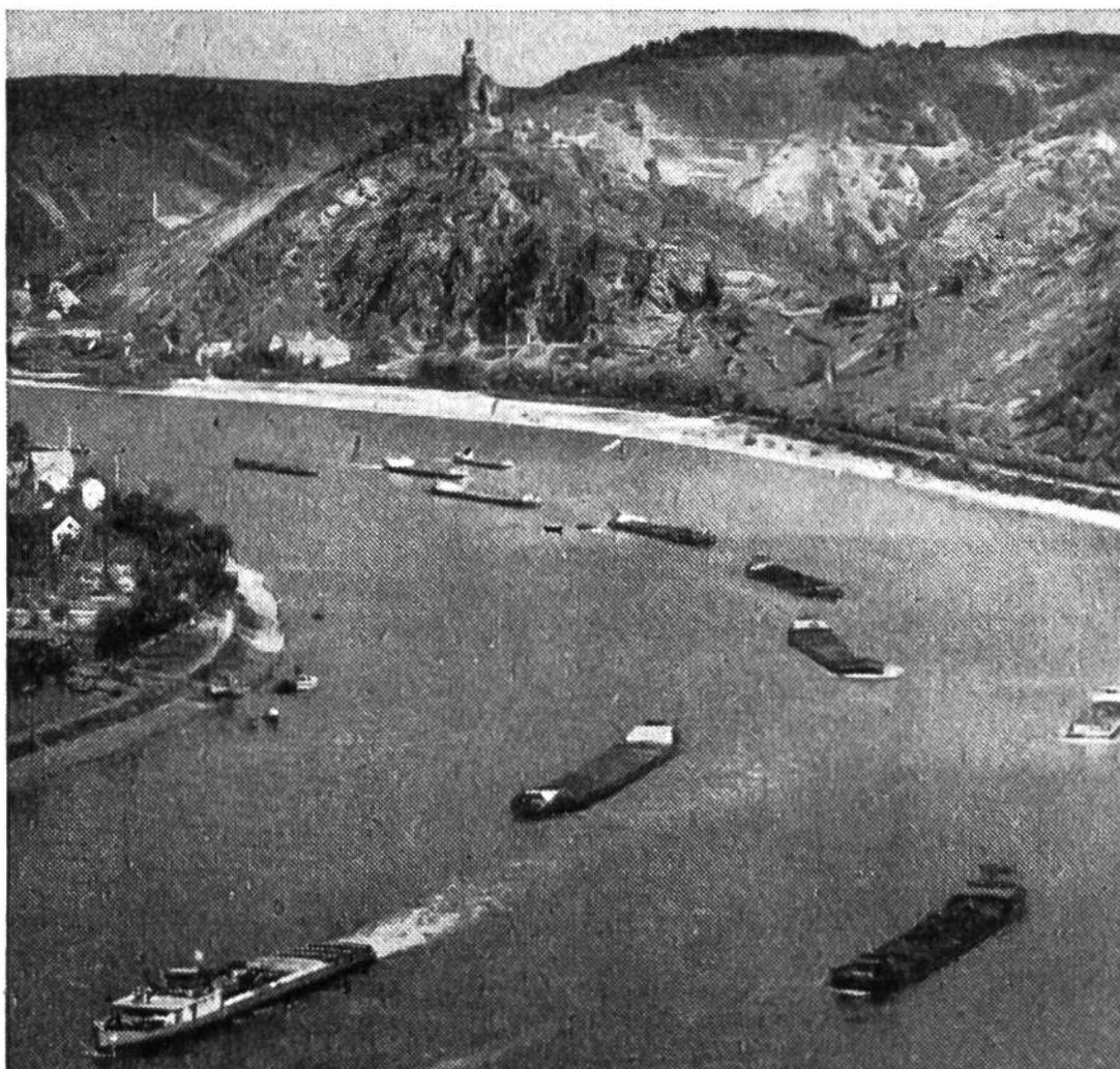
Der Dieselschlepper «Unterwalden» (Bildrand unten links) hat 7 Kähne mit je etwa 1500 Tonnen Ladung im Anhang, von denen jeder mit einer besonderen Schlepptrasse (Drahtseil) mit dem Schlepper verbunden ist. Die beiden Schiffe aussen rechts gehören nicht zum Schleppzug.
