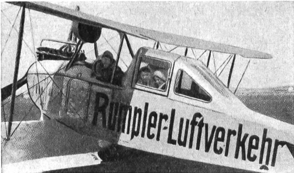
1920: «Rumpler-Luftlimousine», eines der ersten Verkehrsflugzeuge. 2 Passagierplätze in «Luxuskabine mit elektrischer Birne und stoffdrapierten Wänden, Vorhang und Blumenvase». Spannweite 12 m, Fluggewicht 1300 kg. Motorleistung 160 PS. Reisegeschwindigkeit ca. 130 km/h. Reichweite max. 750 km.
