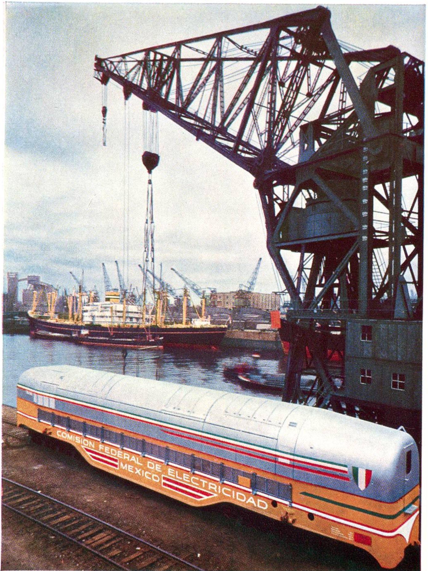
Einschiffung eines fahrbaren Brown Boveri Gasturbinen-Kraftwerkes (Wagen, der die Turbine und den elektrischen Generator enthält) in einem Nordseehafen zum Transport nach Mexiko. Solche Kraftstationen werden in Mexiko dort eingesetzt, wo dringender Mangel an elektrischer Energie herrscht.
