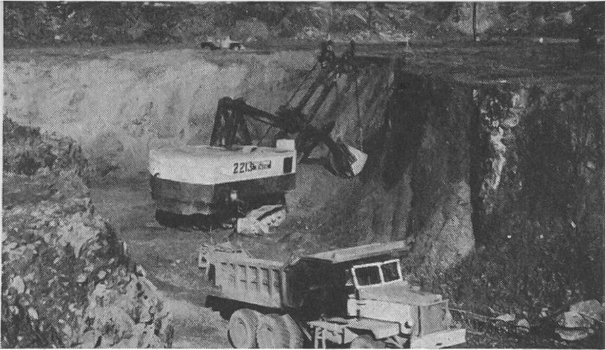
Abbau des losgesprengten Eisenerzes mit Baggern.
