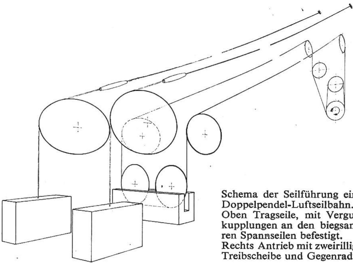
Schema der Seilführung einer Doppelpendel-Luftseilbahn. Oben Tragseile, mit Vergusskupplungen an den biegsameren Spannseilen befestigt. Rechts Antrieb mit zweirilliger Treibscheibe und Gegenrad.
