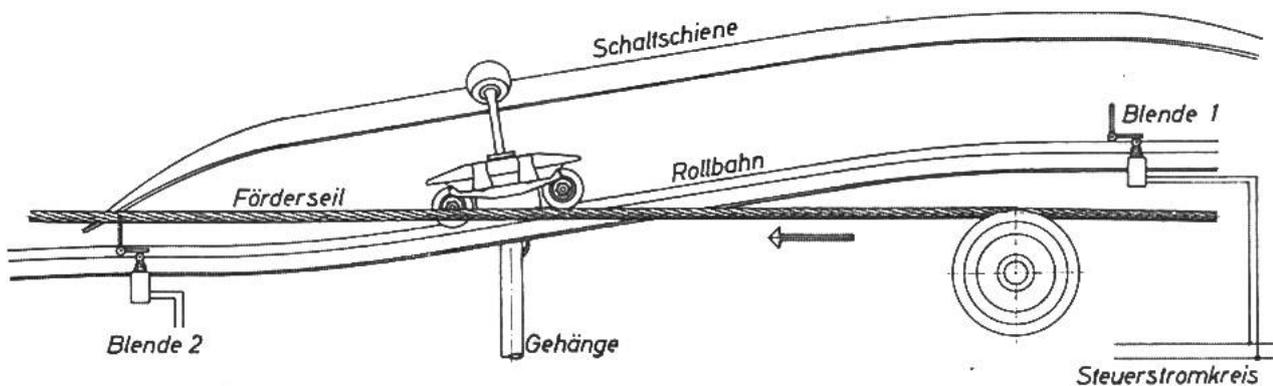
Schematische Darstellung einer Einkuppelstelle. Auf der schiefen Rollbahn wird der Klemmapparat auf die Seilgeschwindigkeit gebracht. Blende 1 prüft, ob der Apparat voll offen ist. Wenn nicht, kippt die berührte Blende um und öffnet den Steuerstromkreis des Antriebsmotors. Sofortige Bremsung folgt. Blende 2 hat die gleiche Wirkung, wenn das Seil schlecht erfasst wurde.
