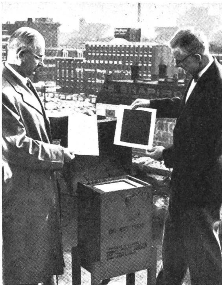
Messung der Luftverunreinigung mit Hilfe von Filtern. Der Mann links hält einen sauberen Filter, der Mann rechts einen schmutzigen. Durch einen in der Kiste montierten Staubsauger wurde eine bestimmte Menge Luft durch den Filter gesogen, wobei Staub und Rauchtteilchen am Filter hängen blieben.
