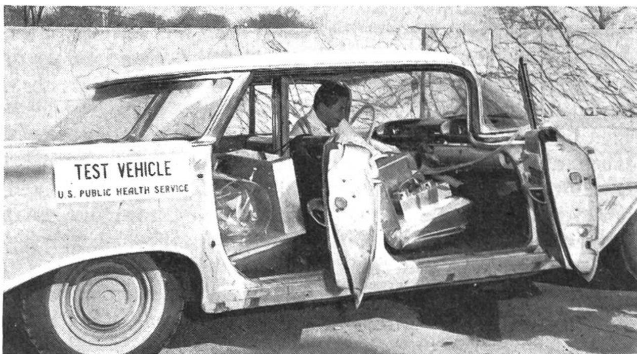
Testfahrzeug der amerikanischen Gesundheitsbehörden. Das Fahrzeug ist mit Instrumenten ausgerüstet, um die Abgase während der Fahrt zu messen.
