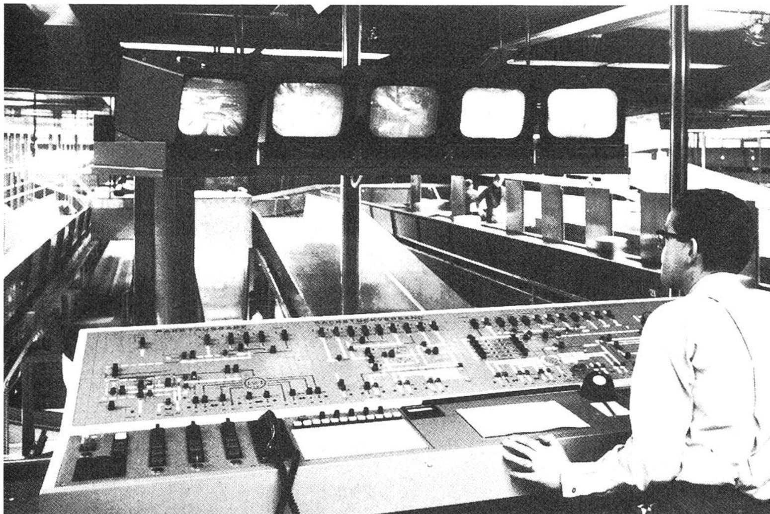
*Fernsehen einmal anders. Der gesamte Betrieb der Paketverteilanlagen wird von einer zentralen Kommandostelle aus gesteuert und überwacht.*
