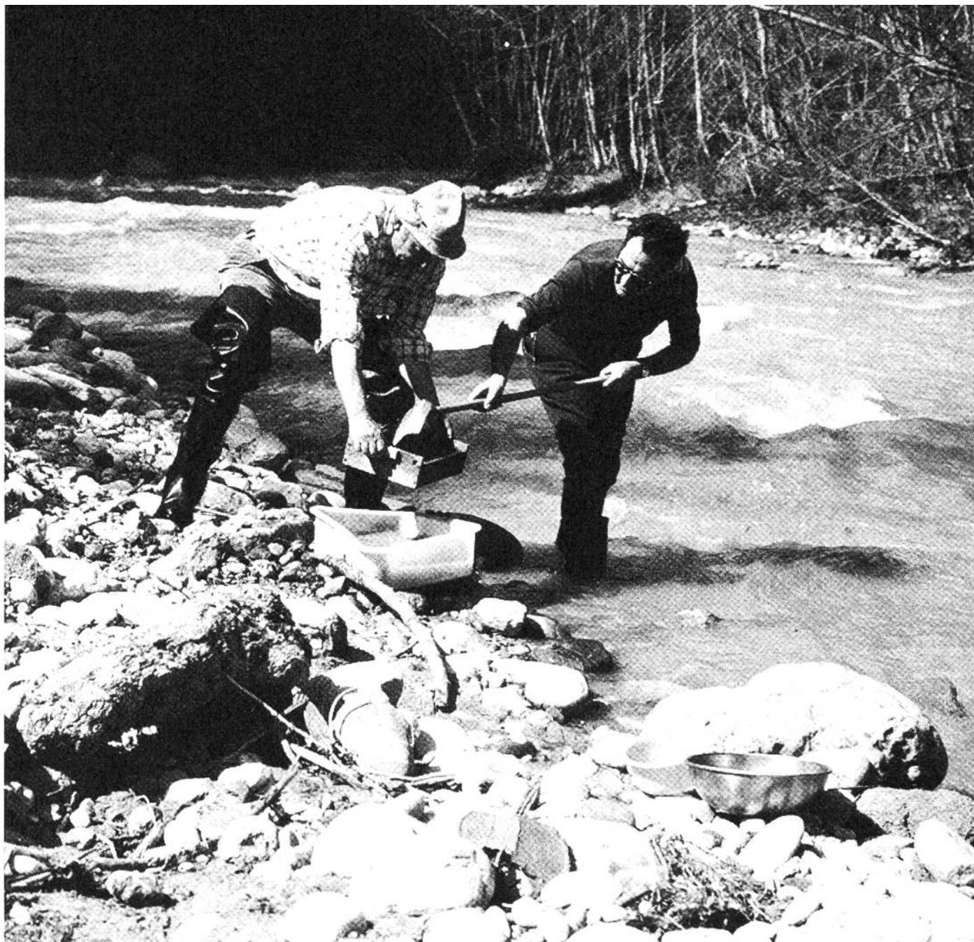
*Am Bachrand lagert der dunkle Mineralsand. Mit der Schaufel gibt ihn der Goldsucher aufs Sieb, das über eine Plastikwanne gehalten wird. Der durchgesiebte Leicht- und Schwersand fällt in das Gefäß.*
