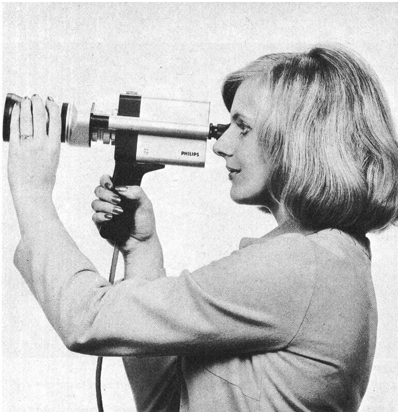
Schwarzweiss-Videokamera mit optischem Sucher und Zoom-Objektiv.
