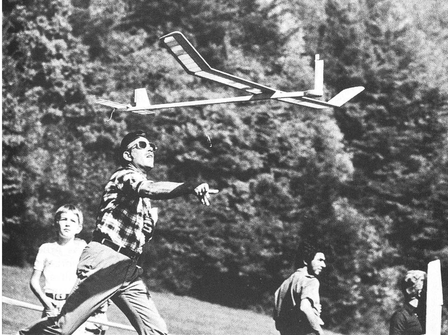
*Charakteristisches Kennzeichen eines Segelflugmodells mit magnetischer Kopfsteuerung ist seine verbreiterte Rumpfnase mit darüber senkrecht emporstehender Steuerflosse. Der Bau eines solchen Fliegers erfordert grosse Sorgfalt und Präzision und ist selbst für Erwachsene eine anspruchsvolle Aufgabe.*
