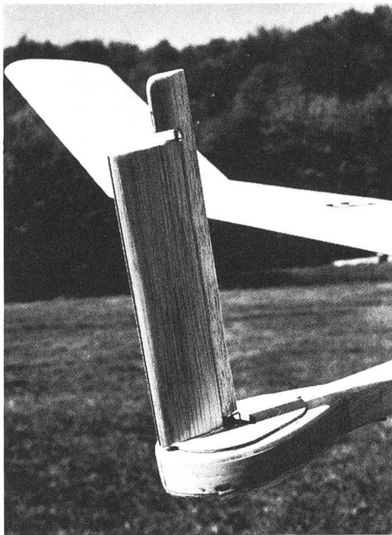
*Und so sieht die Rumpfnase mit aufgesetzter Steuerflosse aus. Was oberflächlich betrachtet höchst einfach anmutet, ist in Wirklichkeit eine aerodynamisch äusserst raffinierte Konstruktion. Im Ausschnitt der Rumpfnase erkennt man ein feines Stängelchen, das ins Zahnrad eingreift und das Steuerruder mit dem Magneten koppelt.*
