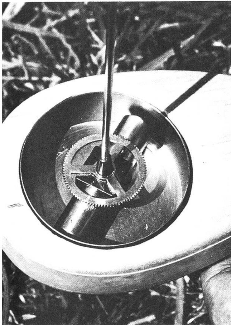
*Dies ist das Herz einer Magnetsteuerung: Ein kleiner Stabmagnet, äusserst reibungsarm gelagert und fest verbunden mit einem Zahnrad sowie der Drehachse für die Steuerflosse. Während der Stabmagnet immer ungefähr Nord-Süd-Richtung einnimmt, wird die Steuerflosse entsprechend dem gewünschten Flugkurs auf die Achse aufgesetzt und mit Hilfe eines in das Zahnrad eingreifenden Stiftes fixiert.*
