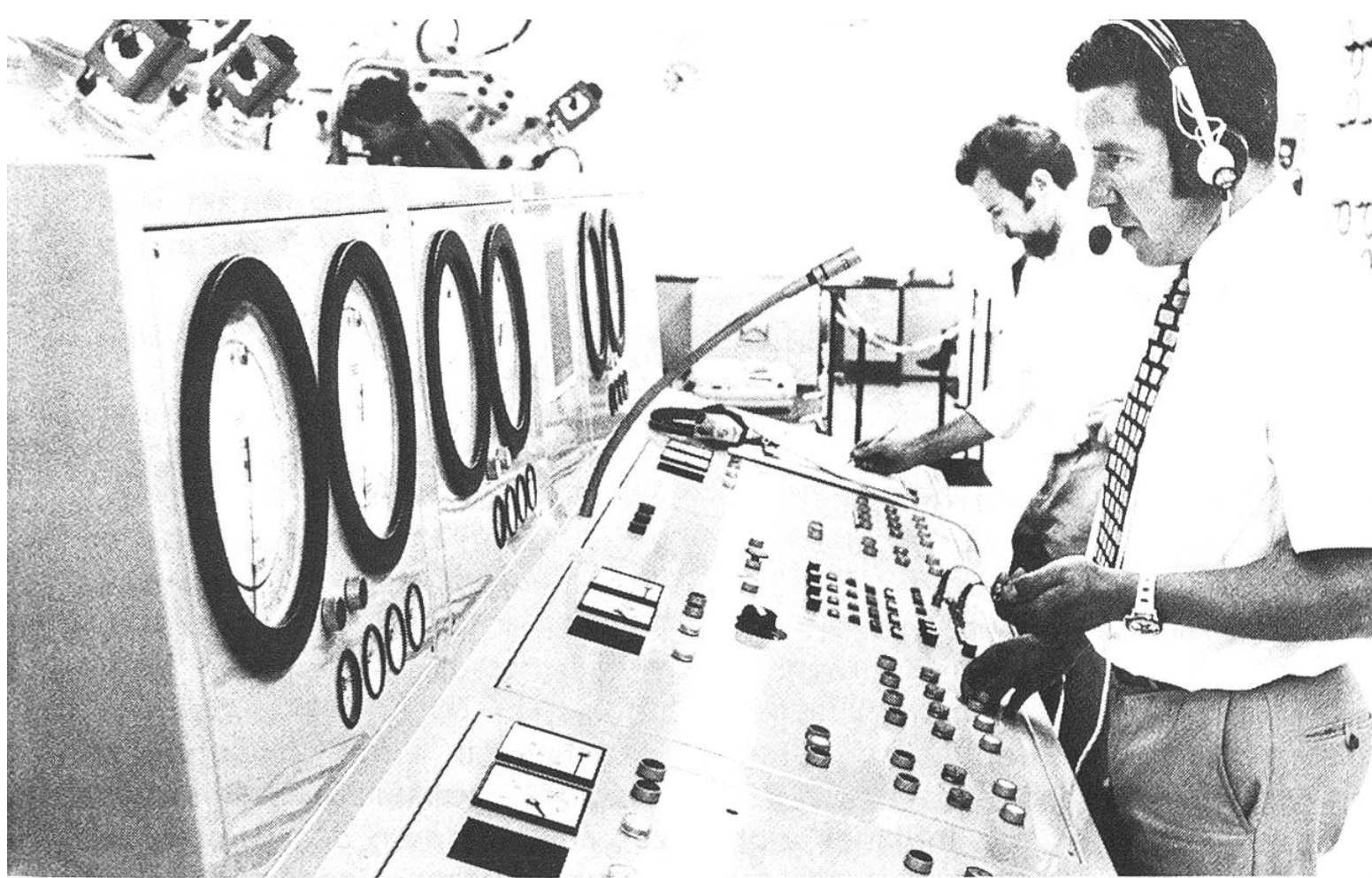
Von diesem zentralen Kommandopult aus steuern und überwachen der technische Leiter des Zürcher Druckkammerlaboratoriums, Benno Schenk, und seine Mitarbeiter sämtliche Vorgänge im Innern des Tauchsimmers.
