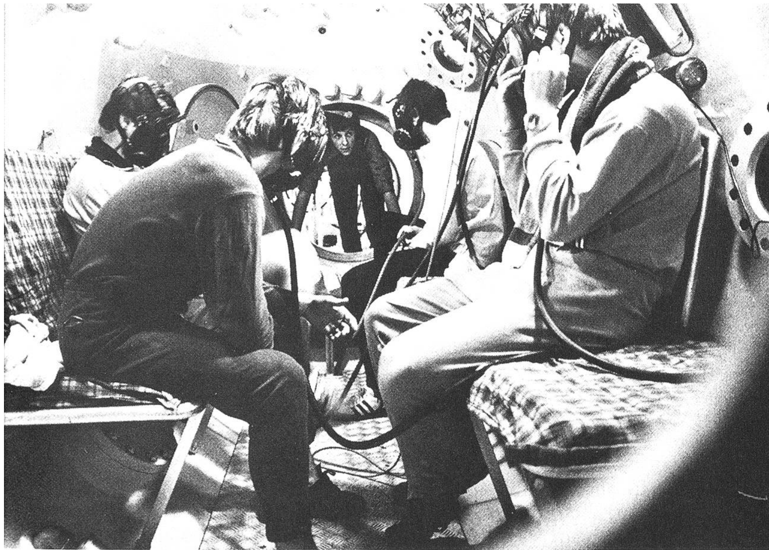
Die Wohnkammer des Zürcher Tauchsimulators. Der Durchstieg im Hintergrund führt in ein kugelförmiges Abteil, unter dem sich eine zweite, wassergefüllte Kugel befindet. In dieser können realistische Unterwasser-Experimente durchgeführt werden.
