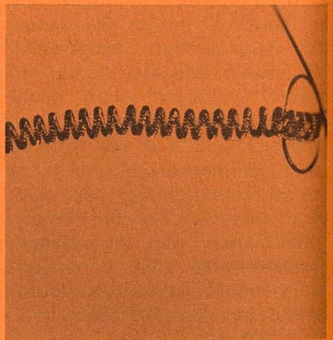
... um über die Konstruktion eines doppelt gewendelten Wolframdrahtes in einer Glühlampe staunen zu können.
