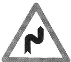
Kurvensignale, z. B. Doppelkurve nach rechts beginnend (Sturzgefahr vor allem bei Gefälle, wo schnell gefahren wird.)
