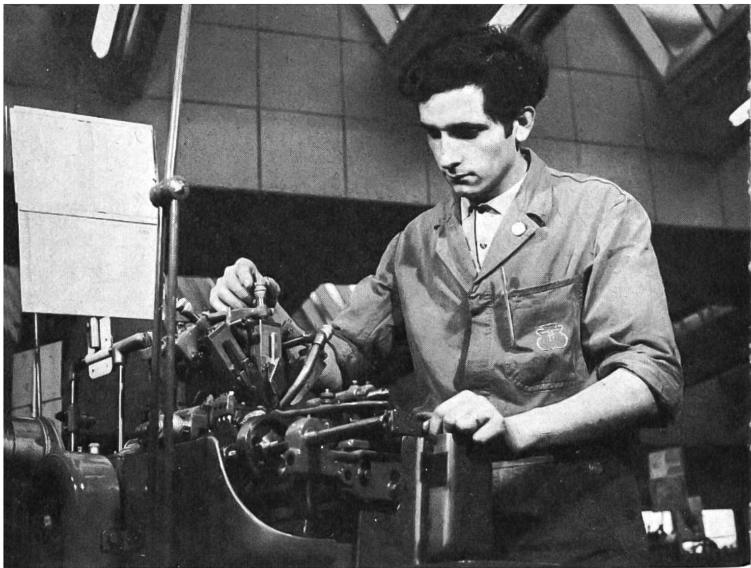
*Der Decolleteur ist für eine Reihe von automatischen Drehbänken verantwortlich. Er führt deren Einstellung aus und überwacht die Produktion.*
