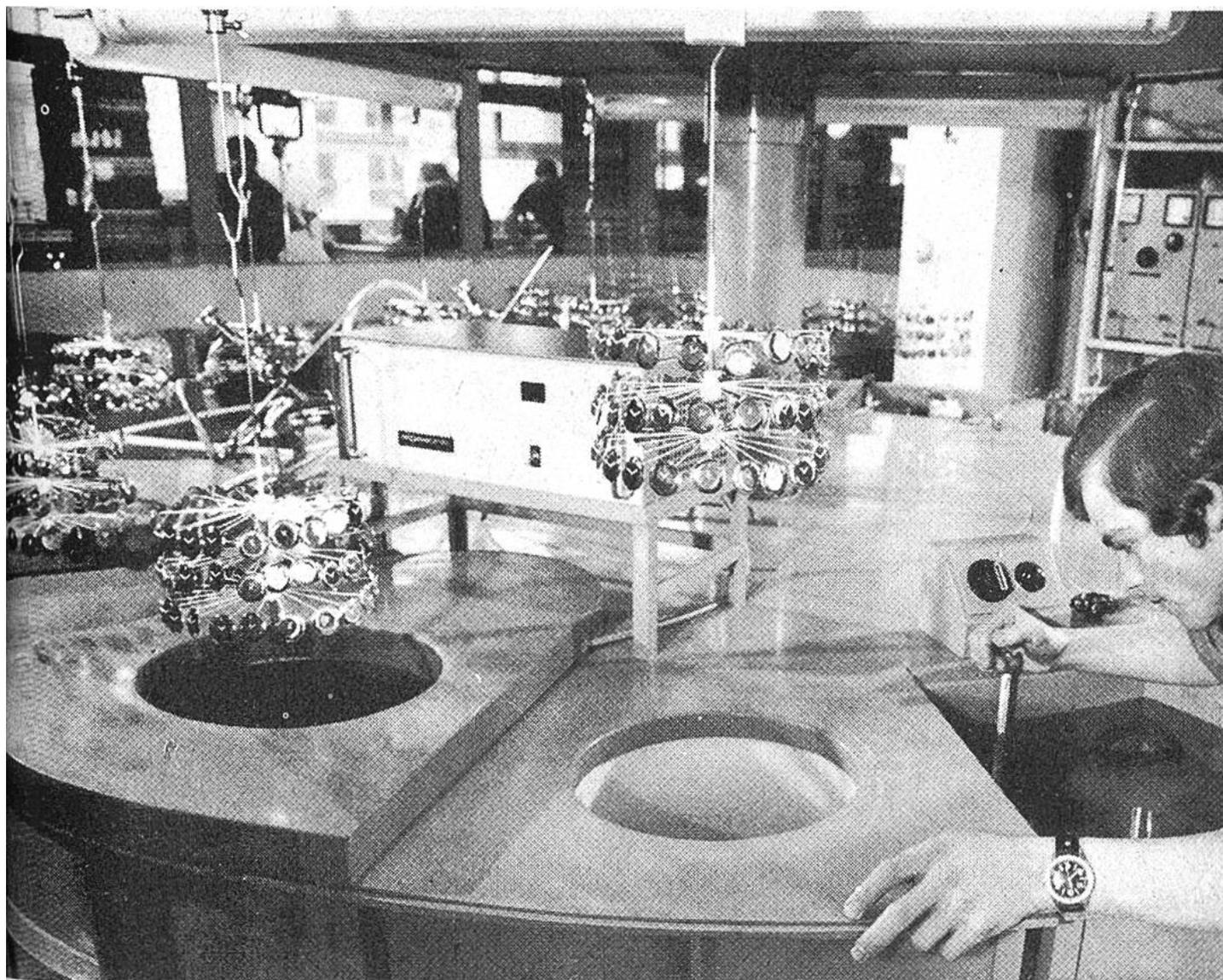
*Der Galvaniseur bereitet im Labor verschiedene chemische Bäder vor, die zur Behandlung der Oberflächen dienen und den Teilen der Uhr die gewünschte Härte und Färbung verleihen.*
