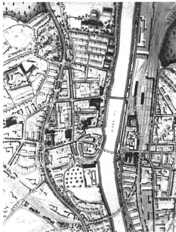
Abb. 4. Projekt 12, Vorschlag für Strasse 2, mit Durchfahung der linksufrigen Stadt. Die Eingriffe in den Bauzustand gehen sehr weit. Die hohen Kosten stünden in keinem Verhältnis zum Erreichten. Man beachte die vielen Kreuzungen und Einmündungen, die für den Durchgangs- wie für den Lokalverkehr hinderlich sind.
