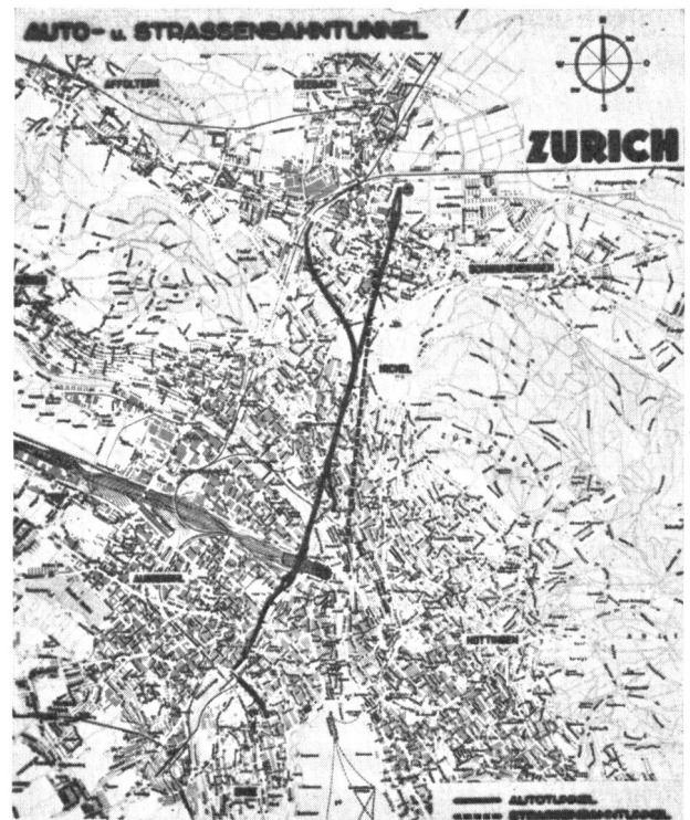
Abb. 3. Projekte eines Strassenbahntunnels und eines sich gabelnden Autotunnels nach dem Kreis II.
