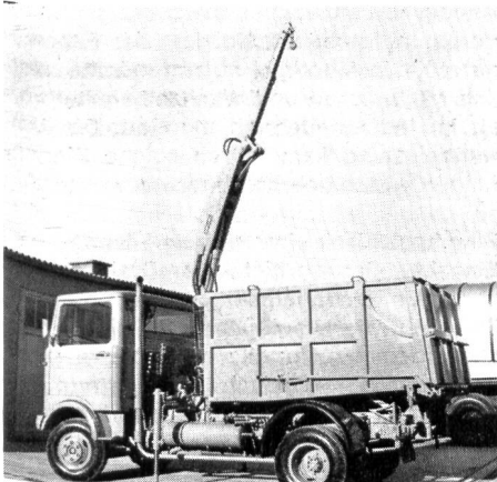
Abb. 3. Das Kuka-Kontiskat-Fahrzeug, ausgerüstet für eine Beladung mittels Kran
