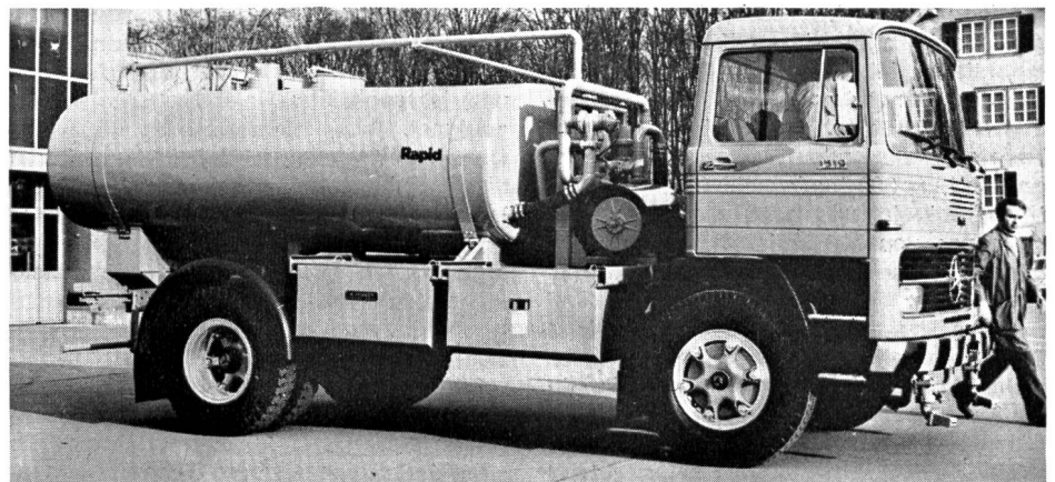
Abb. 7. Der komplett elektrifizierte und daher besonders umweltfreundliche Waschwagen, ausgerüstet mit einem 6800 l fassenden Kunststofftank
