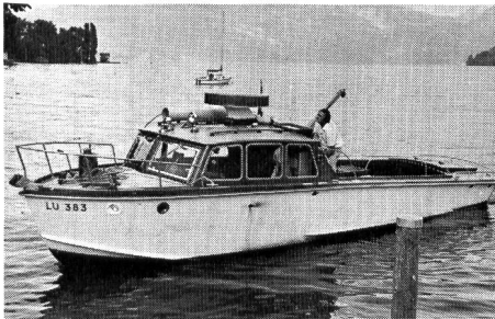
Abb.2. Das grössere der beiden Arbeitsboote des Laboratoriums, «Hans Bachmann», ist mit Sprechfunk, Echograph, Radar und maschinellen Hebezeugen für Messungen und Probenahmen ausgerüstet. Eine kräftige Antriebsmaschine ermöglicht die schnelle Rückkehr ins Laboratorium. Laborarbeit auf dem See kann dadurch grösstenteils vermieden werden
