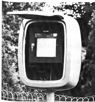
Abb. 1. Arkon-Registriergerät in freistehendem Fiberglasgehäuse eingebaut
