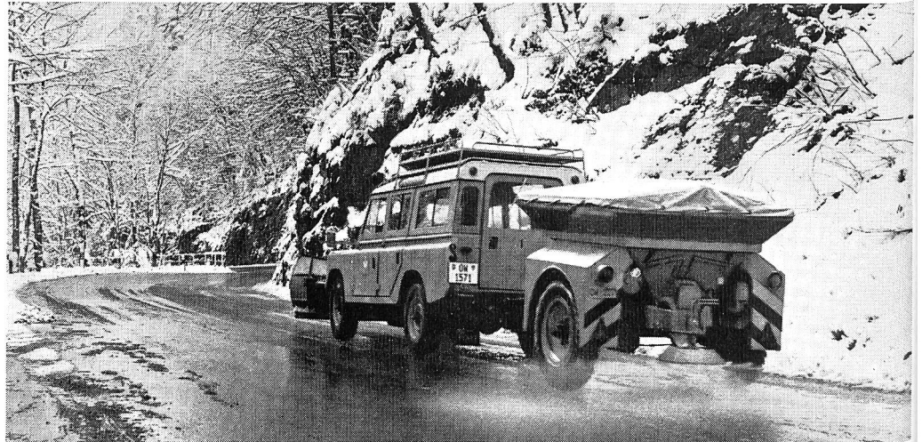
▲ AMA-15H Anhängestreuer für Salz und Splitt. Ausgerüstet mit Druckluftbremse. Ausge- rüstet nach SVG. Typen- geprüft. Inhalt: 1,5 m 3
