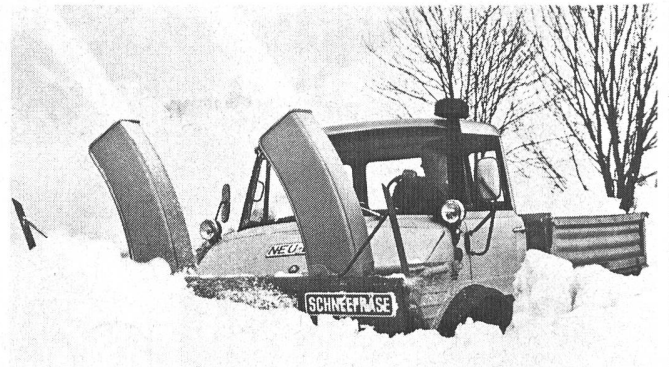
Unimog U 84/406 mit Vorbauschneefräse
