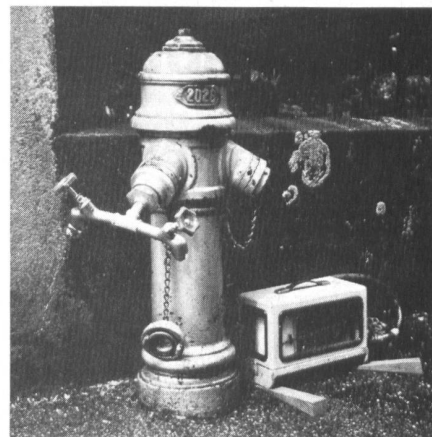
Hydrant mit angeschlossenem Druckschreiber.
