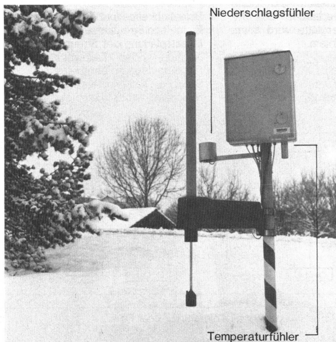
Abb. 7. Auswertelektronik mit Luftsonden und Schneehöhenmesser.
