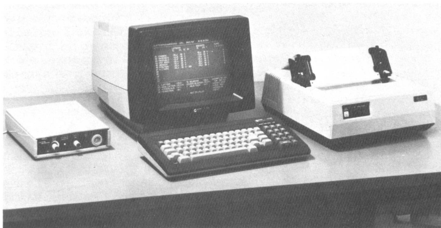
Abb. 9. Anzeigeeinheit mit Bildschirm und Drucker; links Akustik-Alarmgerät.
