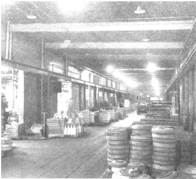
Bild 1a links: Blick in die Caterpillar-Traktoren-Fabrik vor der Einführung von „Color Engineering“. Die schmutziggraue, monotone Umgebung erschwert die Sicht, ist die Quelle von Unfällen und setzt die Leistung der Arbeiter herab. Bild 1b rechts: Blick in dieselbe Fabrik nach der Einführung von „Color Engineering.“ Ohne Änderung der Beleuchtung ist durch die Wahl reflektierender Anstriche die Sicht wesentlich verbessert und eine freundlichere Arbeitsstätte geschaffen worden, in der die Gefahr von Unfällen wesentlich geringer ist. Gleichzeitig ist die Produktivität dieser Werkstatt beträchtlich gesteigert worden.
