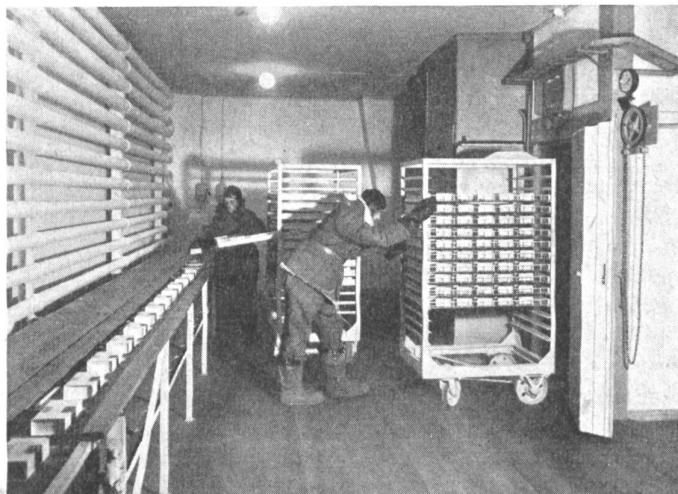
Bild 1 oben: Transportable Gefrieranlage, welche zur Erntezeit in die Anbaugelände fährt, um die frisch gewonnenen Früchte oder Gemüse an Ort und Stelle zu konservieren. (Aufnahme Birds Eye, Zürich)
