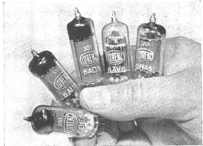
Abb. 9. Und das ist das Endprodukt des langwierigen Arbeitsganges. So klein sind die Allglasröhren aus der international eingeführten Miniaturröhrenserie
