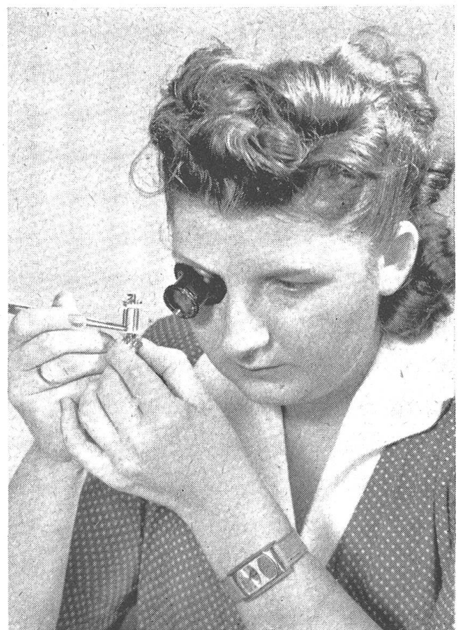
Abb. 6. Allein feinfühligere Frauenhände können die zarten Röhrensysteme mit der geforderten Präzision aufbauen. Hier die Montage einer Miniaturröhre
