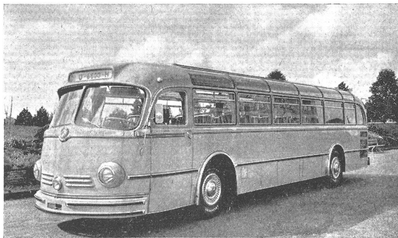
Der neue Mercedes-Benz-Großomnibus „O 6600 H“ mit quer im Heck eingebautem 145-PS-Sechszylinder-Dieselmotor und elektrisch geschaltetem Sechsgang-Getriebe
