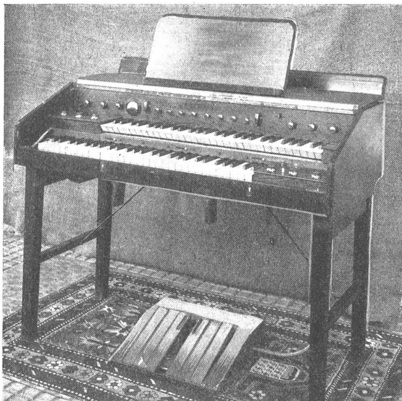
Abb. 4. Das Heliophon, das zur Zeit vollkommenste Musikinstrument auf elektronischer Grundlage. Die Pedale sind lediglich durch ein Mehrfachkabel mit dem Instrument verbunden, das über ein Dutzend Röhren enthält
