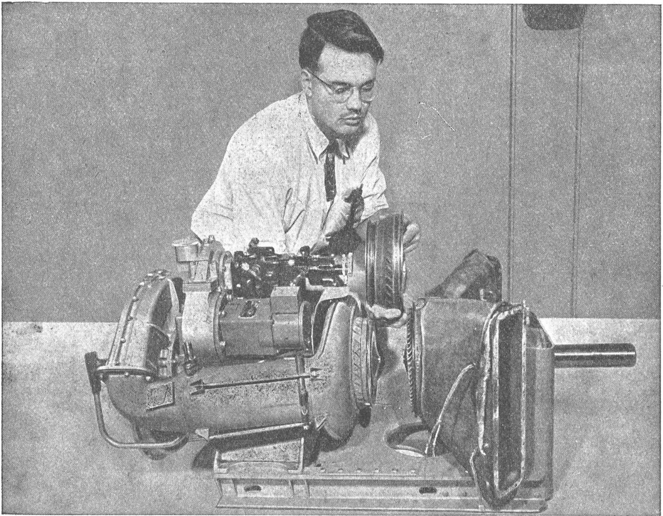
*Das ist die Boeing-502-Doppelgasturbine für Lastkraftwagen. Der herausgenommene Teil ist die Düsenbüchse, welche die Aufgabe hat, die aus der Verdichterturbine (links, zusammen mit Luftkanal, Anlasser und Verdichter) ausströmenden Treibgase in die Nutzturbine (rechts, zusammen mit Auspuffleitungen und Abtriebswelle) hinüberzuleiten. Eine starre Verbindung von Verdichter- und Nutzturbine besteht nicht*
