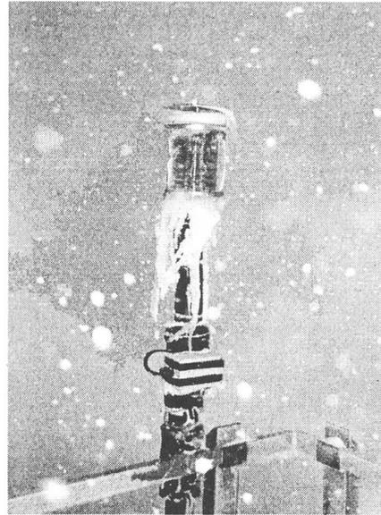
**Figure 5:** Tête d'aspiration de la station du Jungfraujoch
