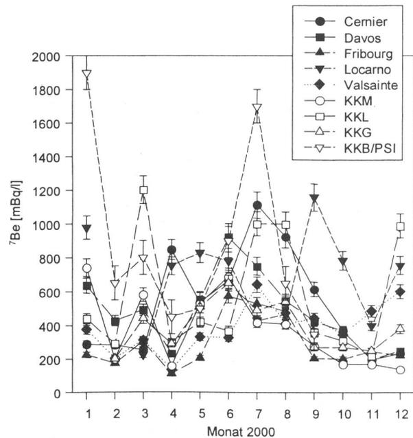
**Fig. 6:** <sup>7</sup>Be im Regen an den Standorten Cernier, Davos, Fribourg, Locarno und Valsainte, KKM, KKG, KKL und KKB/PSI. (KKB/PSI: Messungen des PSI)
