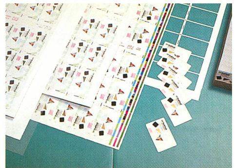
**Im Tapelayer werden die bedruckten Vorlagen mit Deckfolien und Magnetstreifen versehen.**
