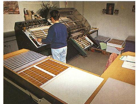
**In einem Arbeitsgang werden die noch anonymen Karten (vorne) von einer Maschine personalisiert und couvertiert (hinten).**
