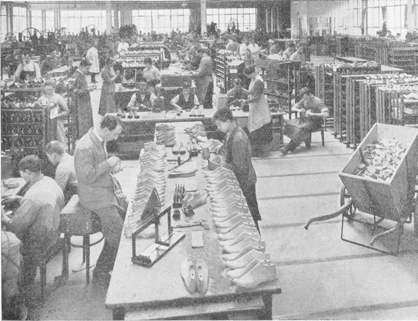
Fabrication des formes de montage. (Usines Bally à Schoenenwerd)
