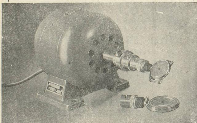
Machine électrique à remonter les montres
