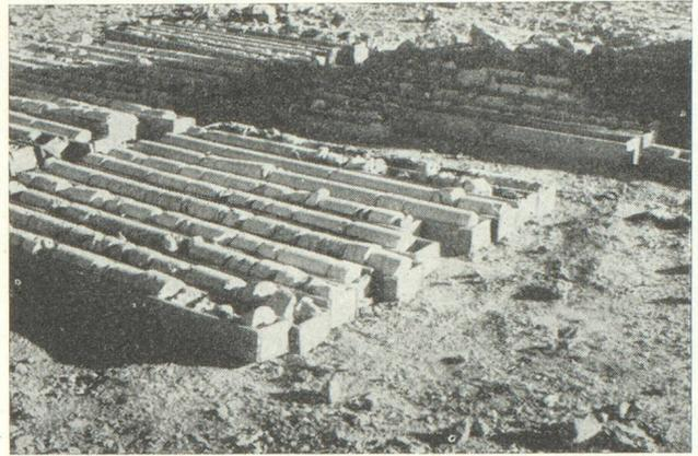
La construction d'un barrage nécessite des travaux de préparation considérables. Voici des carottes de sondages effectués à Djorf Torba, à l'ouest de Colomb-Béchar.
