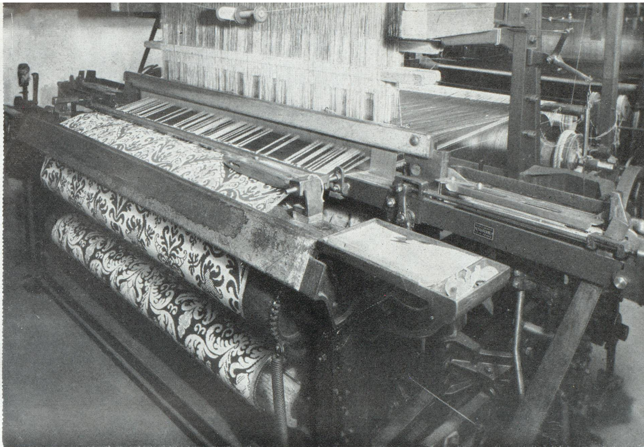
Un type de métier à soie tissant de chatoyeux tissus Les fils de trame sont reliés au mécanisme Jacquard
