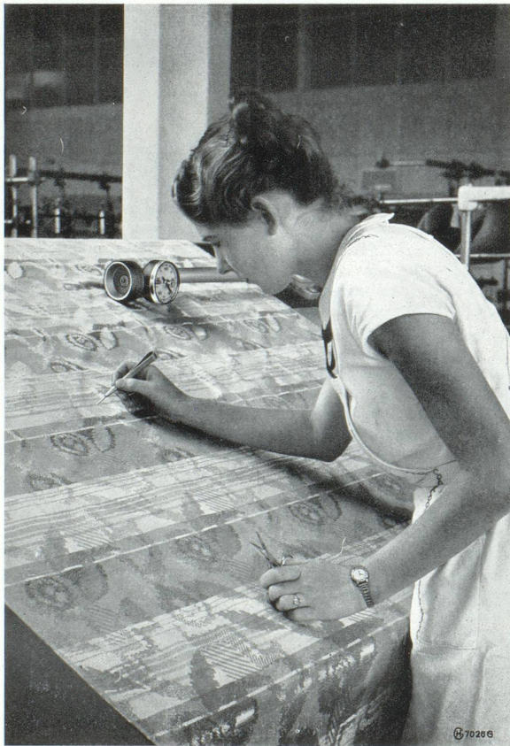
Le compteur métrique Hasler, monté sur un métier de contrôle de tissus de la fabrique de machines Rüti S. A., est un compteur totalisateur qui se prête spécialement pour des machines rapides et pour déterminer la longueur des tissus dans l'industrie textile (Hasler S. A., Berne)
