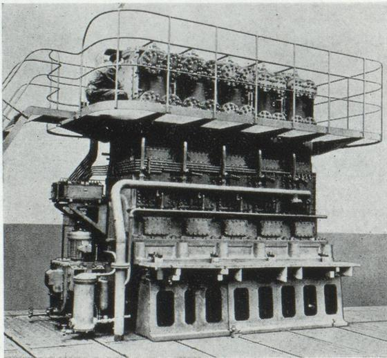
Compresseur Burckhardt à 2 étages pour gaz de four à coke
