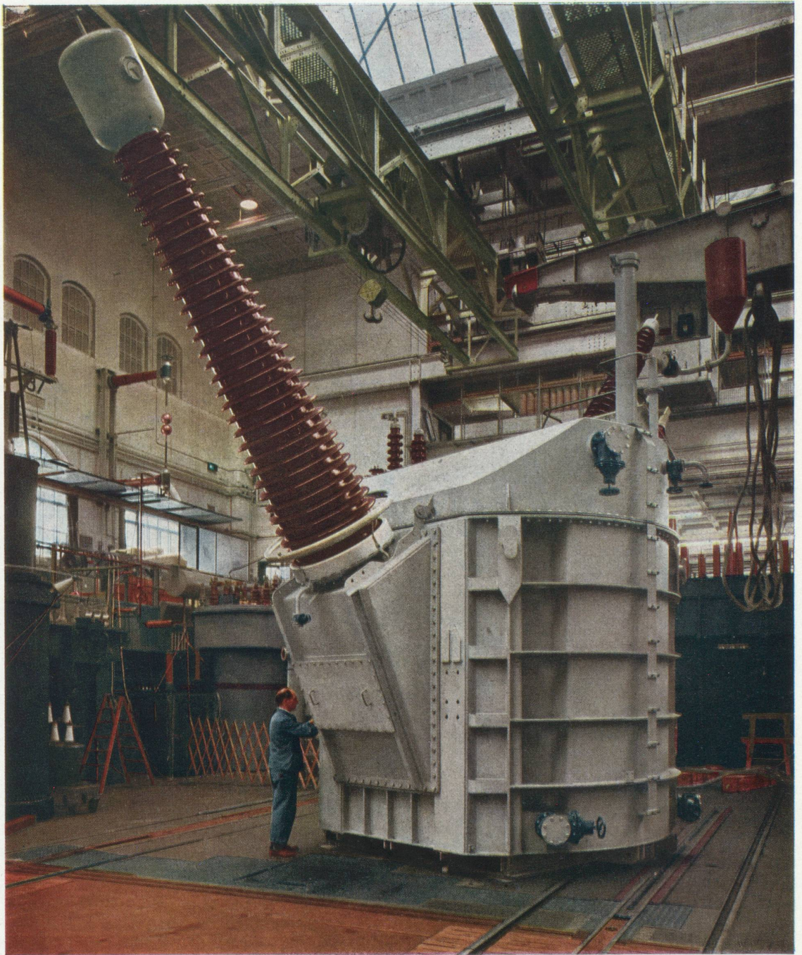
Un auto-transformateur monophasé Brown-Boveri destiné à une centrale hydro-électrique européenne.
