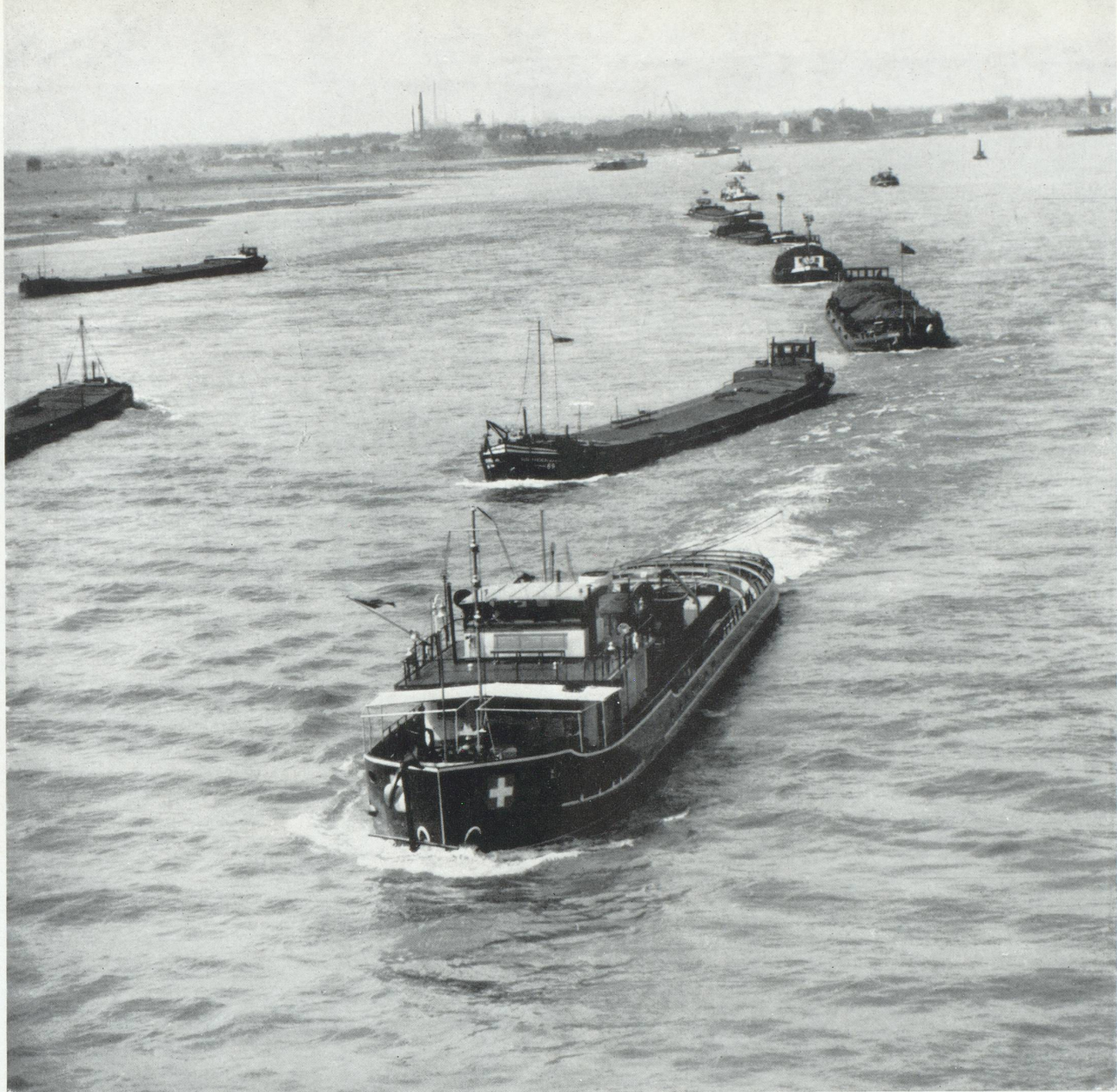
Remorqueur " Rudolf Miescher ", de la Lloyd A.G.. tirant sur le Bas-Rhin cinq barques lourdement chargées.
