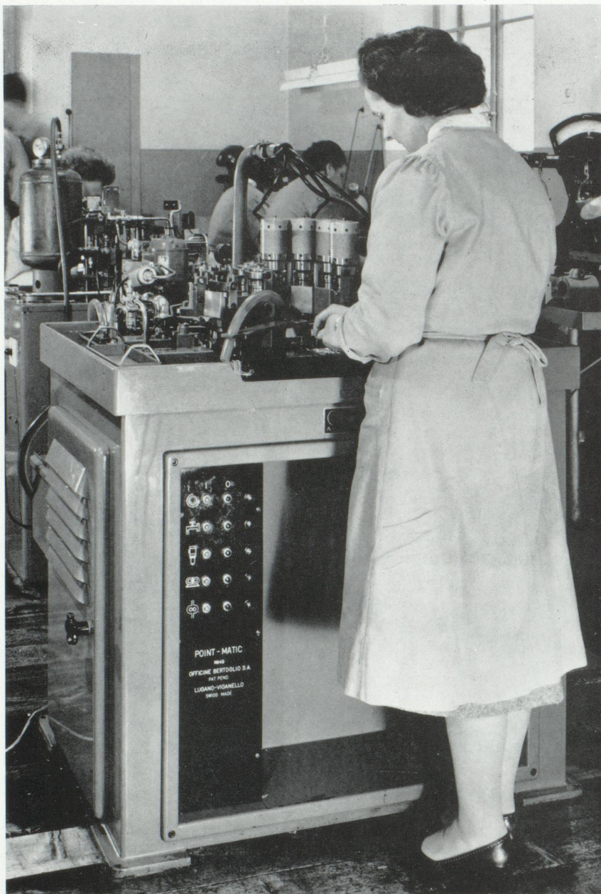
Fabrication des cartouches. Usinage complet des pointes de cartouches.
