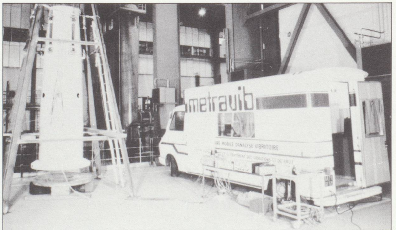
Laboratoire mobile d'analyse vibratoire.
