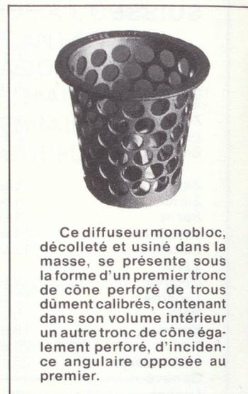
Ce diffuseur monobloc, décollé et usiné dans la masse, se présente sous la forme d'un premier tronç de cône perforé de trous dûment calibrés, contenant dans son volume intérieur un autre tronç de cône également perforé, d'incidence angulaire opposée au premier.
