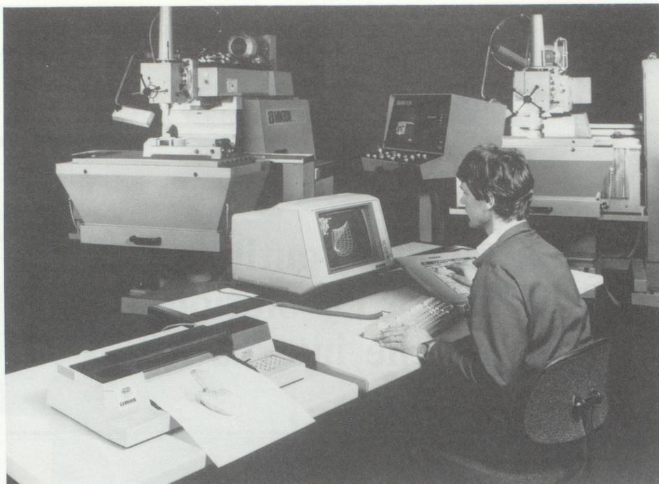
Place de programmation NC pour conception et fabrication assistée par ordinateur (CAO/FAO), à écran graphique et table traçante par coordonnées (Illustration : Mikron S.A., Bienne).
