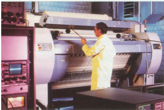
Mesure du bruit sur une machine à tisser M8300. Le niveau sonore de cette machine est deux fois plus bas que celui des systèmes de tissage en usage actuellement. © Sulzer Management SA.
