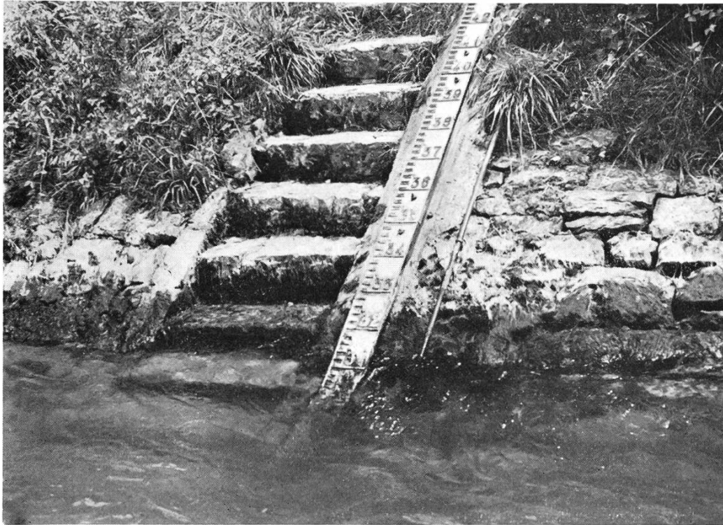
Bild 3. Pegel. (Gusseiserner Böschungspegel, die Zahlen bedeuten Dezimeter Wasserspiegelhöhe über dem Pegel-Nullpunkt.)
