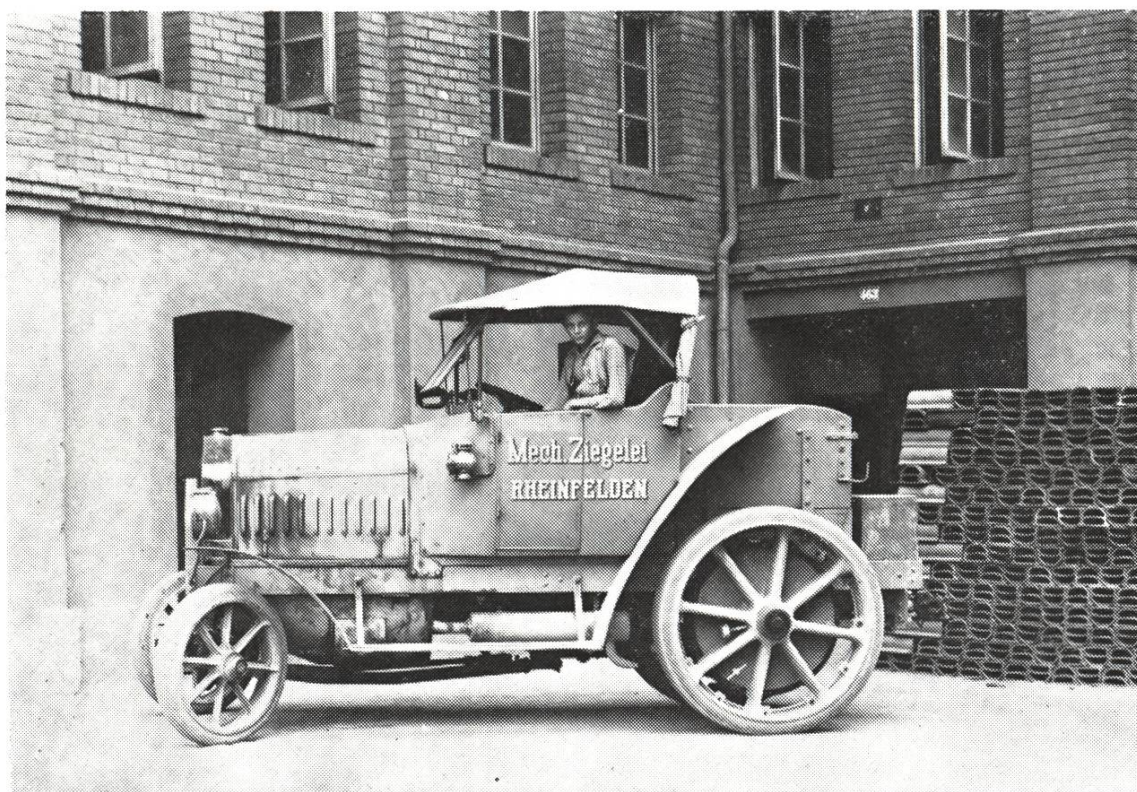
Der für die damaligen Verhältnisse starke Berna-Traktor mit Kettenantrieb und Vollgummireifen. Mit dem Abgang des letzten Pferdeknechts Häseli war nach 1918 der Fuhrbetrieb motorisiert worden. Abb. 7
