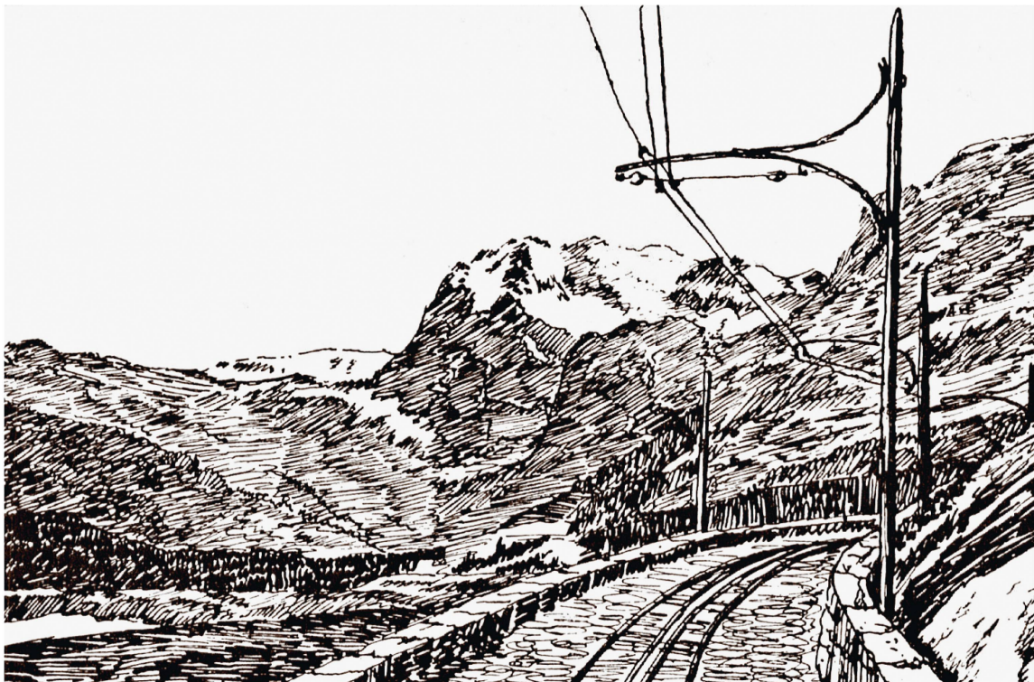
Fig. 7. Le même tracé amélioré par la construction de deux murs en pierres sèches.
