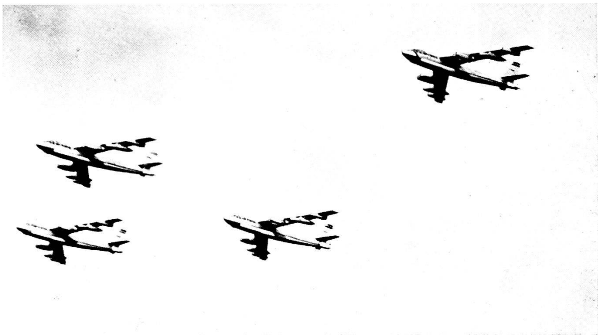
La formazione degli « STRATOJET » B-47. Questi bombardieri atomici hanno sorvolato Dübendorf provenienti dalle basi aeree americane dell'Africa del Nord! Oltre ai sei motori a reazione, applicati in due gruppi per parte, si notano al di sotto delle ali i serbatoi supplementari. (USA)
