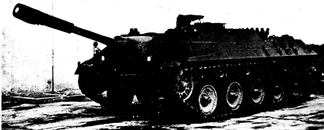
Carro da caccia con can (BRD) — dati tecnici: peso: 25,7 t (pronto al cbt) — Armamento: 1 can 90 mm (51 colpi); 2 mitr 7,62 mm — Motore/potenza: Diesel 500 PS; rapp potenza/peso: 19,5 PS/t; velocità max: 70 km/h; autonomia: 400 km - Equipaggio: 4 uomini.
