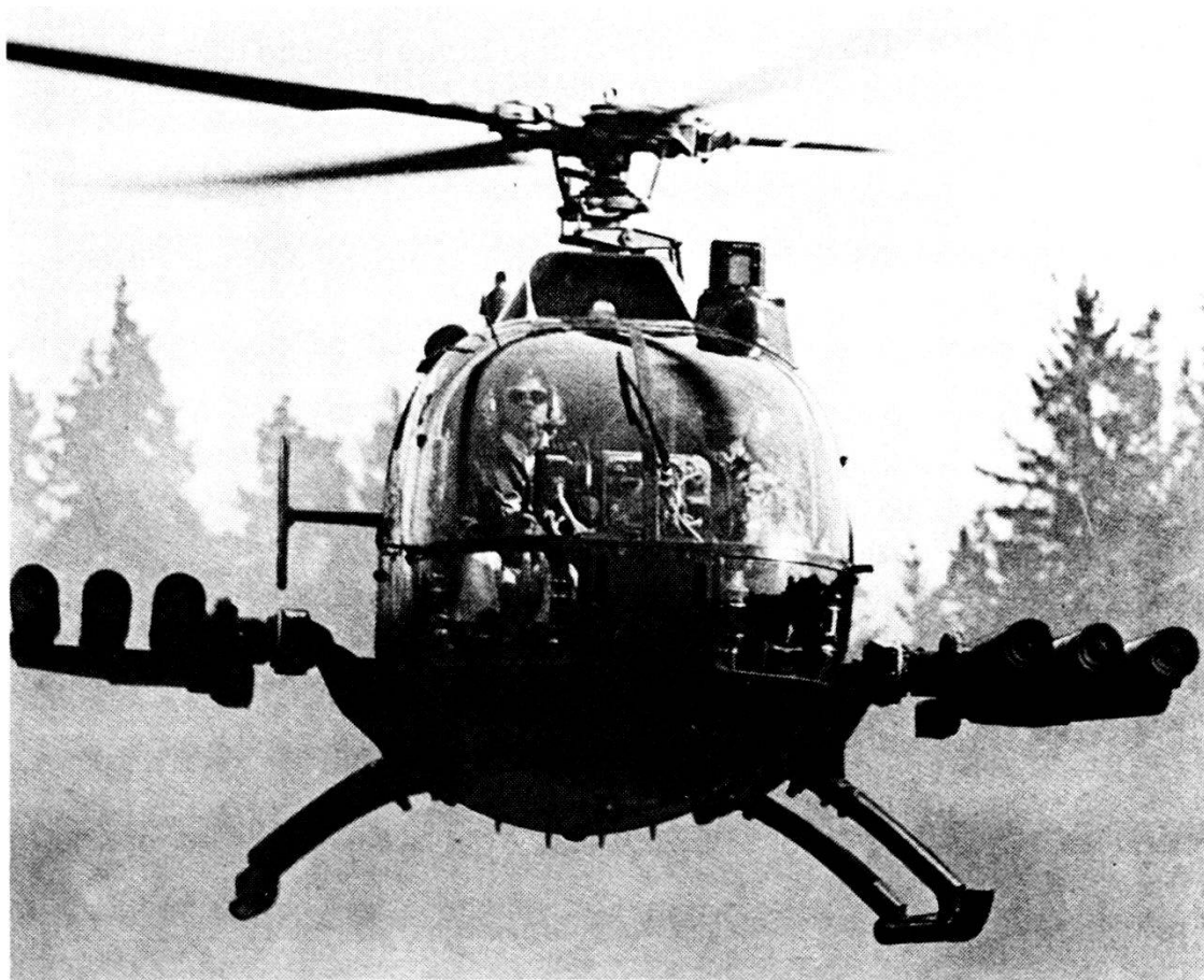
PAH 1, BO 105 con ordigno teleguidato HOT (fabbricazione: Messerschmitt-Blohm-Bölkow).
